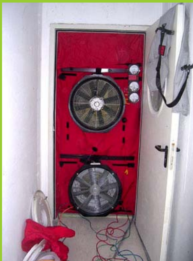
Bild 5.1 — Einbausituation einer Blower-Door; Quelle: BlowerDoor GmbH
