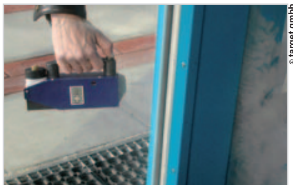
Фигура 7: Тест за въздухоплътност – изпускане на въздух през пропускащи прозрачни рамки, визуализирано чрез мъгла
