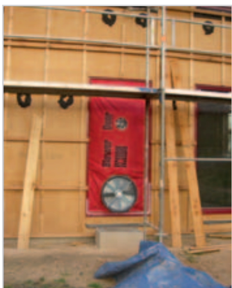
Фигура 9: Тест за въздухоплътност през строителния период
