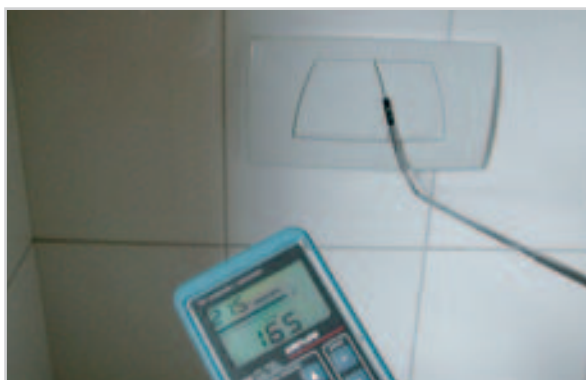
Фигура 6: Тест за въздухоплътност – изпускане на въздух в използваните фитинги и арматури, измерване с анемометър
