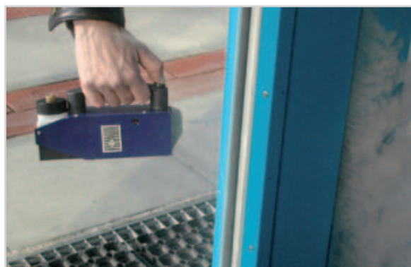
Photo 2 Verifica di ermeticità – passaggio di aria nelle discontinuità del telaio delle finestre reso visibile con l'impiego di fumo
