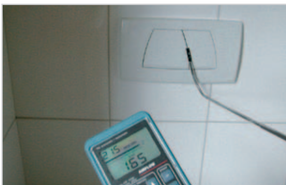
Photo 1 Verifica di ermeticità – passaggio di aria nelle prese elettriche, misurazione con l'anemometro
