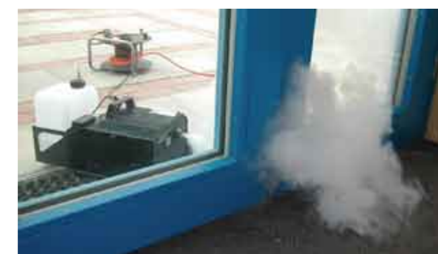
Leckagen werden durch Nebel sichtbar gemacht.
