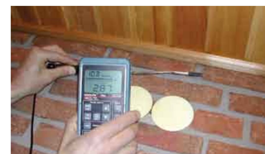
An der Innenwand des Wohnraums strömt Luft mit fast 2,9 m/s ein.
