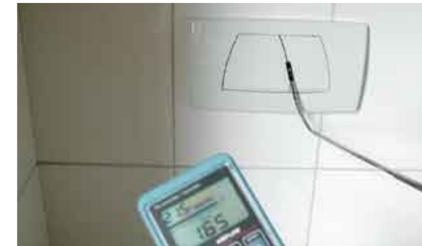
Luft einströmung durch die Drucktaste eines WC-Spülkastens
