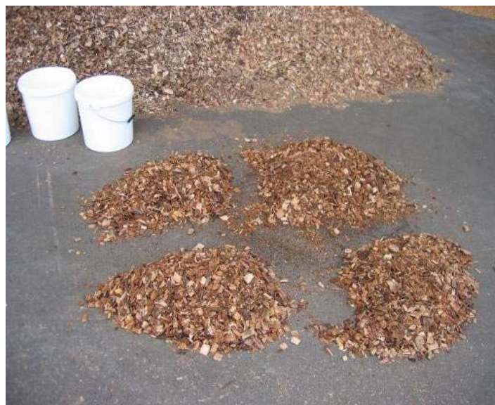
Probenteilung per Hand „Anhäufen und Vierteilen“
