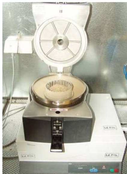
Probenaufbereitung mittels Ultrazentrifugalmühle
