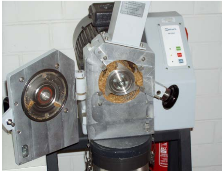
Probenaufbereitung mittels Schneidmühle
